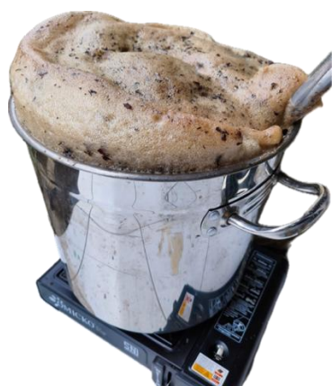
Gambar 3. Hidrolisis tanpa antibusa.
