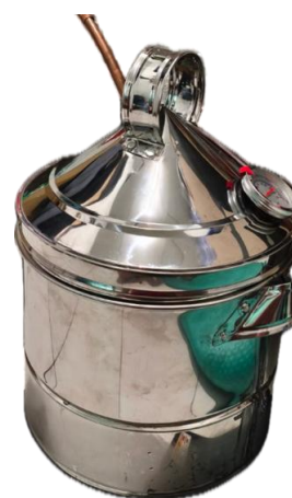
Gambar 5. Desain alat distilasi sederhana dari dandang nasi.
