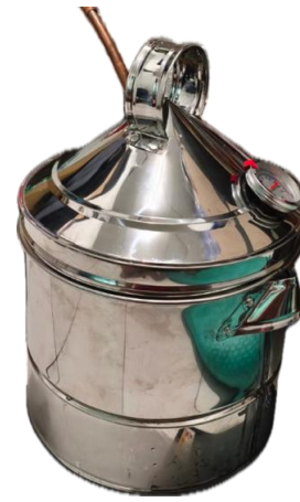
Gambar 5. Desain alat distilasi sederhana dari dandang nasi.
