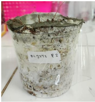
Gambar 5. Penampakan salah satu sampel bio-foam dengan perlakuan jamur tiram 60% dan fermentasi 4 hari
