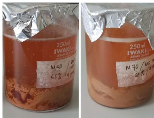
Gambar 8. Hasil Ekstraksi iradiasi ultrasonik Pada Serbuk Ukuran 40 mesh (a) dan 70 mesh (b)
