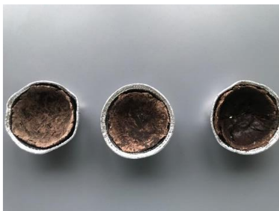
Gambar 1. Biofoam dari kulit singkong dan daun angsana, dari kiri ke kanan sampel 3, sampel 2, dan sampel 1
